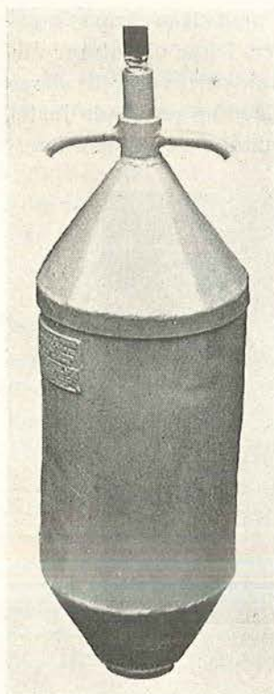
Fig. 19. Svømmevibrator med 20 cm diameter.
